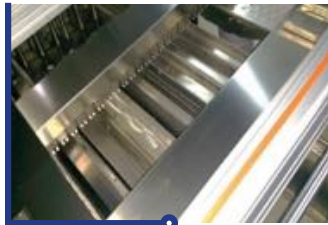
Pot (Olla) con doble ola totalmente de aleación de Titanio para proceso libre de plomo (Lead Free)
